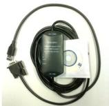
**Интерфейс USB** Скорость - 300 бит/с — 1 Мбит/с Разъем - USB разъем типа A **Интерфейс PPI (RS485)**
