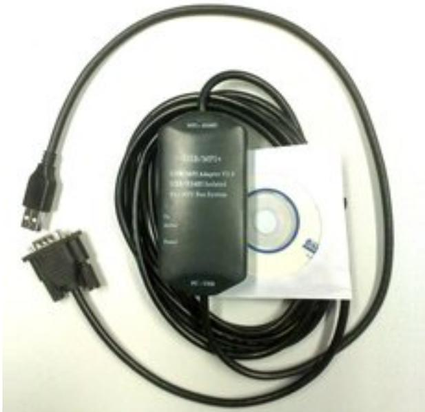
Конвертер протоколов (адаптер) **USB-MPI** аналог адаптера **SIEMENS # 6ES7972-0CB200XA0**
